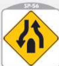
SP-56 FINAL DE VÍA CON SEPARADOR DOS SENTIDOS
